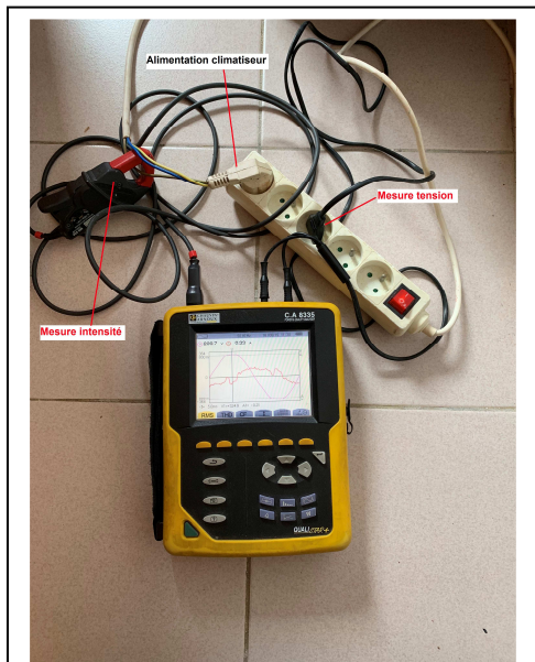
Photo 4 : Branchement de l'analyseur
